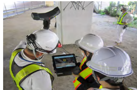
ハンディスキャナによる橋梁点検
