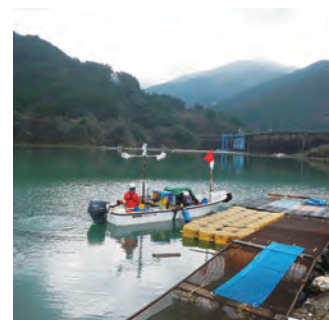
マルチビームによる堆砂測量
