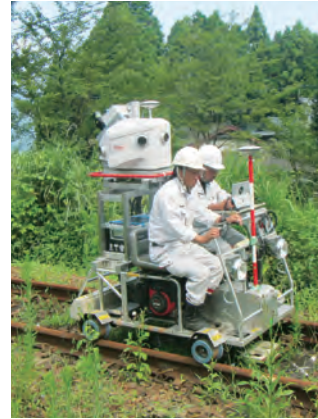
3D計測：車載写真レーザ測量システム (MMS: Mobile Mapping System)
