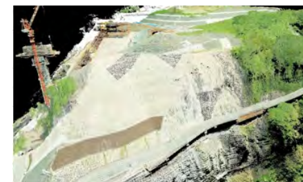
被災後の地形変位の早期把握にUAVレーザで計測
